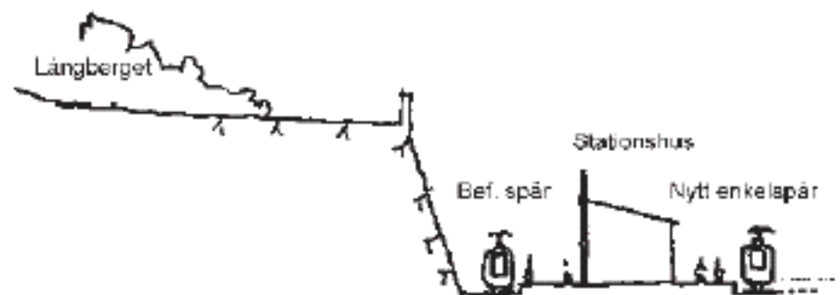
Bild nr 38. Principlösning med nytt spår kring befintlig stationshus. Planskild plattformsförbindelse är inte redovisad. Skala ca 1:1 000.
